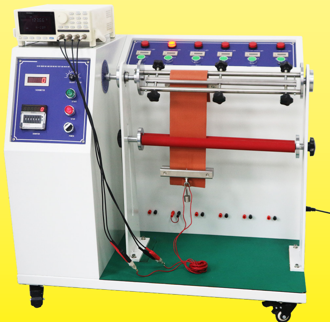
Flexible Silikonheizung während des Biegetests
